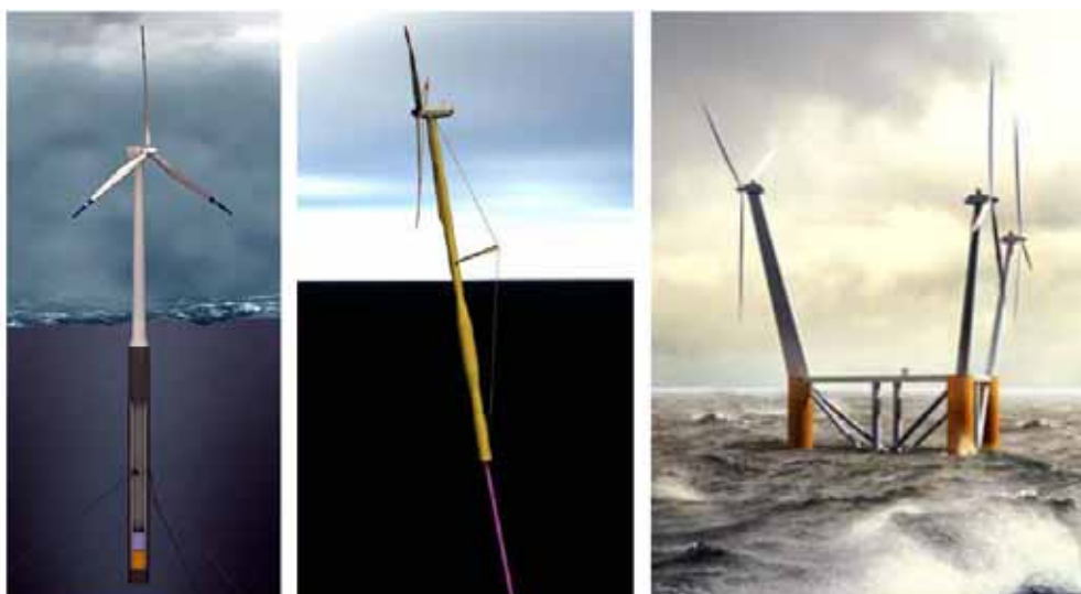
Figur 3.4 Norske konsepter for flytende vindturbiner, fra venstre Hywind, Sway og WindSea
