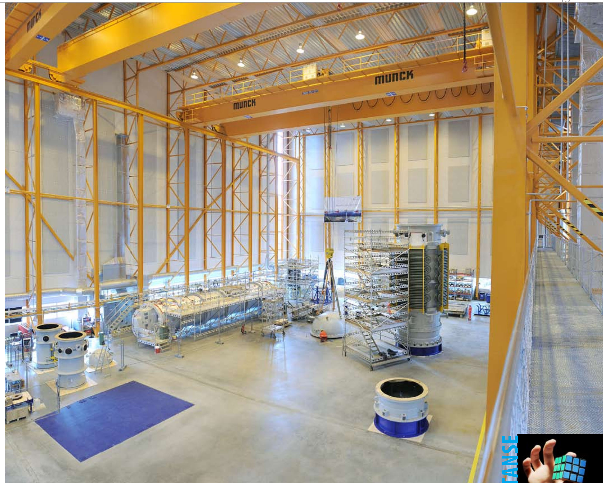
Ormen Lange-piloten vil måle 35 x 6,5 x 13 meter og veie 1100 tonn når den er ferdig sammenstilt.
